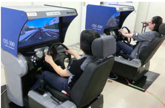
図 8 ドライビングシミュレータ DS-300 及び実験風景
