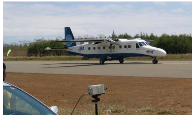
地上走行モデルを検証する飛行実験：手前は高速度カメラ
