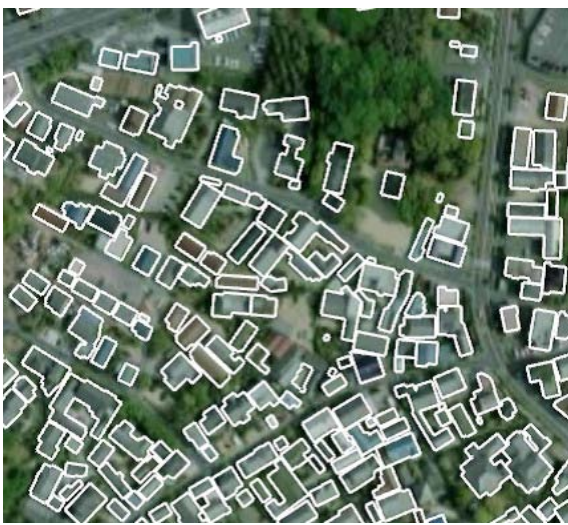
図 10 地図データから建物のフットプリントを抽出した状態：わかりやすいように航空写真を背景に重ねており、白線部分がフットプリントを表す。
