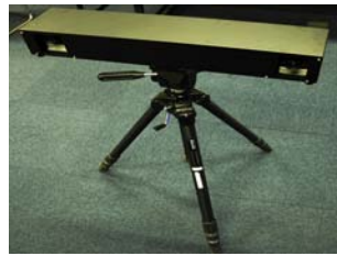
(b) ステレオカメラユニット：基線長 75cm
