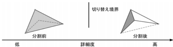
図 11 地形分割のポッピング：モデル切り替え境界にて形状が突然変化する。
