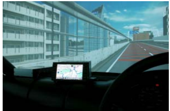
図12 ドライビングシミュレータに実装したカーナビゲーションシステム
