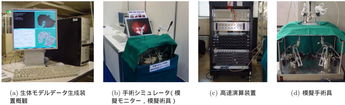
図 10 開発した手術シミュレータ計算基盤の概観：生体モデル生成装置，手術シミュレータ本体からなる．手術シミュレータは高速演算装置部と模擬術具部よりなる．高速演算装置は模擬の程度により計算能力の増減が可能．また，模擬術具も模擬手術に応じて換装が可能．
