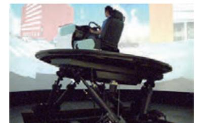
電動6自由度モーションシステム+ターンテーブル
