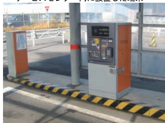
新潟空港駐車場に納入した クレジットカード精算対応精算機
