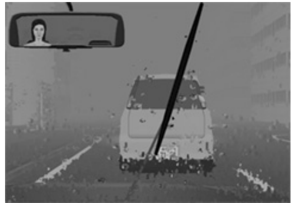
図6 雨滴とワイパーを模擬したマルチパス映像表示例
